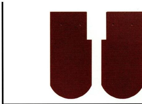
V škridlách je treba vyrezat kolidujúce zámky (horný a dolný - týka sa keramických škridiel).
