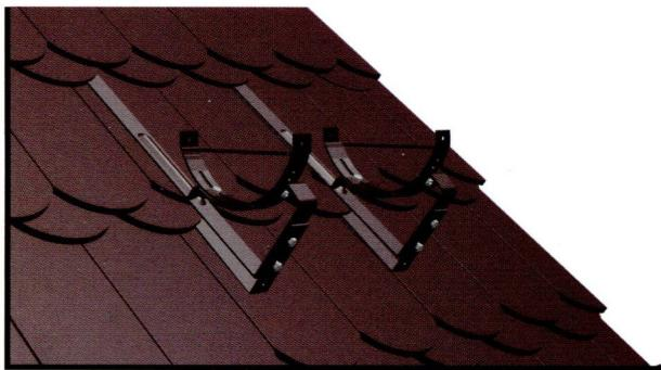
Konzoly typ S alebo SD sú univerzálné držiaky, ktoré sa hodia na väčšinu modelov betónových aj keramických škridiel. V prípade škridly bobrovky je vhodnou konzolou typ S. Konzola SD je dedikovaná pre korunový vzor. V oboch prípadoch by mala byť rozteč lát v bode pripojenia strešnej komunikácie cca 16 cm.
